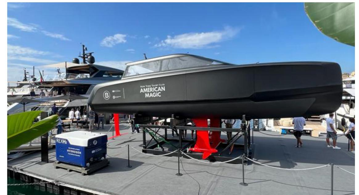
**REXH<sub>2</sub><sup>®</sup>** Le REXH<sub>2</sub><sup>®</sup> permet de convertir l'hydrogène stocké à bord d'un navire en électricité. Cette dernière peut servir pour l'alimentation du moteur électrique comme des auxiliaires de bord, pour tous types de navires, professionnels ou de plaisance.
